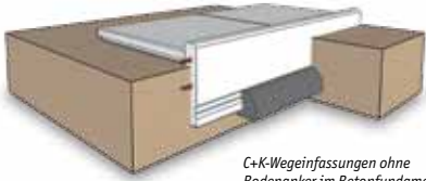
C+K-Wegeinfassungen ohne Bodenanker im Betonfundament. Bordure de chemin C+K sans ancrage au sol dans les fondations en béton
