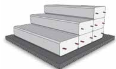
Verklebung der Blockstufe als Stufenanlage auf festem Untergrund. Collage du bloc de marches sur un sol ferme.
