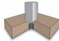
Einfundamentierung der Palisade mit Hilfe des Montagerohres auf losem Untergrund. Encastrement de la palissade à l'aide du tube de montage sur sol meuble.
