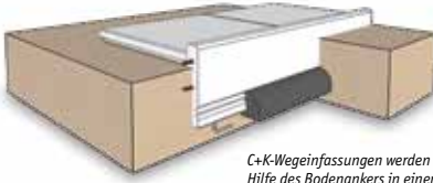
C+K-Wegeinfassungen ohne Bodenanker im Betonfundament. Bordure de chemin C+K sans ancrage au sol dans les fondations en béton
