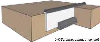
C+K-Betonwegeinfassungen mit Gummigranulatüberzug werden bodengleich eingebaut.
